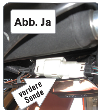
Bei 2007-2015 Softail Modellen finden sie die Steckerverbindung der original Lambdasonde für den vorderen Zylinder in der Nähe des Regler (Abb. Ja), für den hinteren Zylinder unter dem Sitz in der Nähe der Batterie (Abb. Jb).
