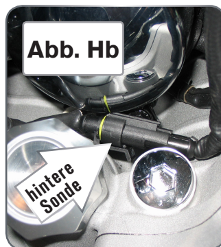
Bei 2007-2009 Touring Modellen und 2007-2011 Softails finden sie die Steckerverbindungen der original Lambdasonde für den vorderen Zylinder in der Nähe des Regler (Abb. Ha), für den hinteren Zylinder in der Nähe des Öltanks (Abb. Hb)
