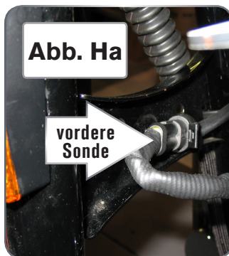
Bei 2007-2009 Touring Modellen und 2007-2011 Softails finden sie die Steckerverbindungen der original Lambdasonde für den vorderen Zylinder in der Nähe des Regler (Abb. Ha), für den hinteren Zylinder in der Nähe des Öltanks (Abb. Hb)
