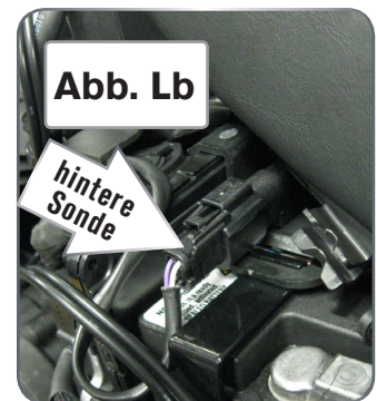
Bei Sportster Modellen befindet sich die Steckerverbindung, für den vorderen Zylinder, immer an der Motorvorderseite in der Nähe des Ölfilter (Abb. La). Die Verbindung für den hinteren Zylinder (2007-2013) an der Motorrückseite (ohne Abb.). Bei 2014-2015er Modellen bindet sich die Steckerverbindung auf der Batterie (Abb. Lb).
