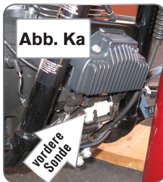
Bei 2006-2015 Dyna Modellen finden sie die Steckerverbindung der original Lambdasonde für den vorderen Zylinder in der Nähe des Regler (Abb. Ka), für den hinteren Zylinder unter dem Sitz (Abb. Kb).
